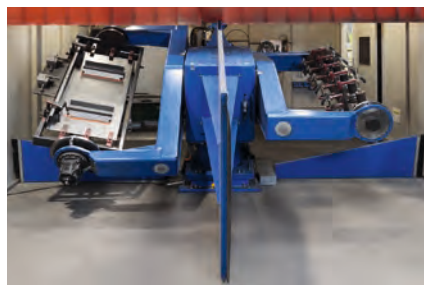
Imposant: der YASKAWA Fünfachs-Servopositionierer R2C mit seinen zwei Stationen für zeitgleiches Bestücken und Schweißen.
