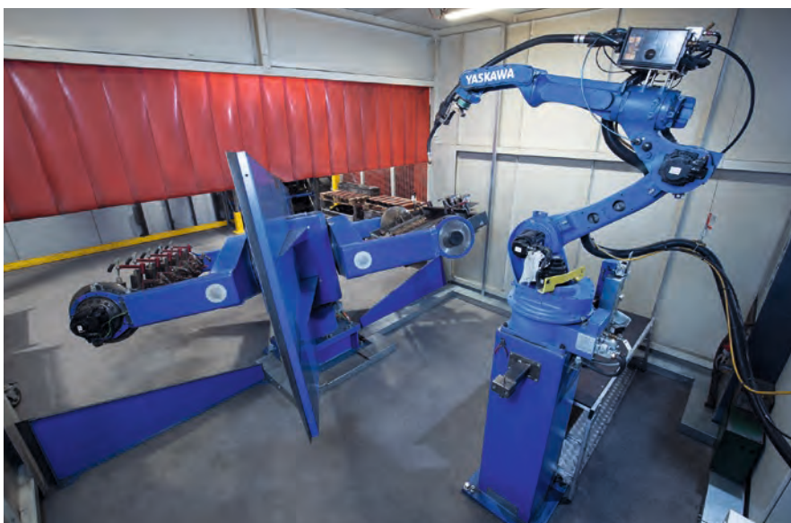
Mit dem fünfschichtigen 2-Stationen-Positionierer von YASKAWA kann auf einer Seite bestückt und auf der anderen geschweißt werden.
