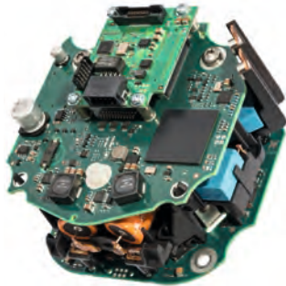
Steuergerät zur Regelung der Motordrehzahl der Ölpumpe im proaktiven Fahrwerkssystem des GLE von Mercedes-Benz
